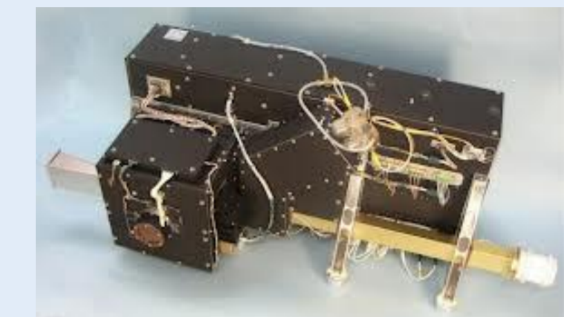
Figure 2 : Le spectromètre de masse COSIMA. Il a pour dimensions 986x356x362mm et pèse 17,5kg.
